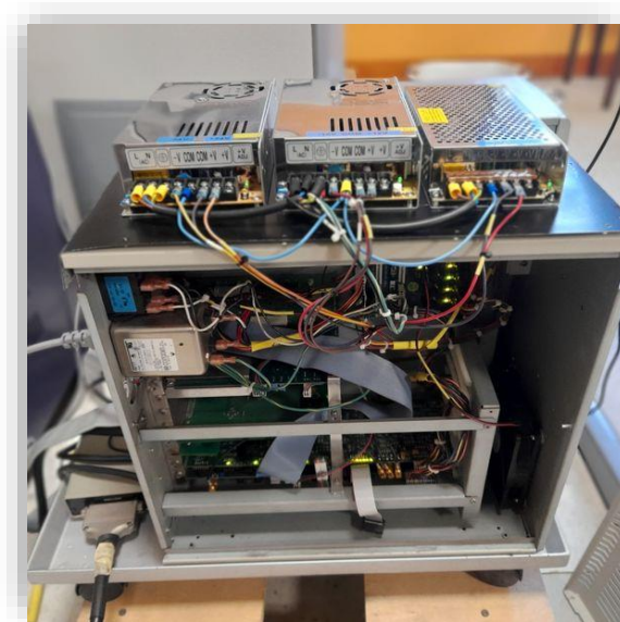
Figura 1 – Sistema de EDS com as 3 fontes de alimentação adquiridas. Uma vez que estas fontes de alimentação não cabem na caixa tiveram de ficar de fora.
